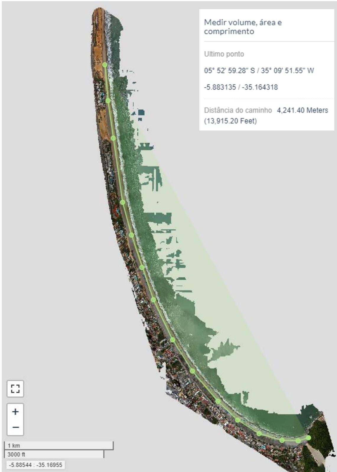
Figura 07 – Ortorectado com a medição aproximada do comprimento de praia executado.
