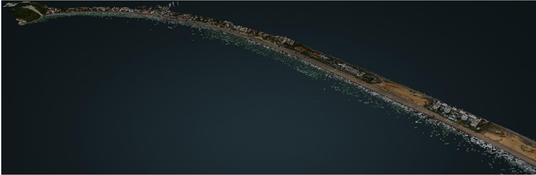
Figura 08 – Modelo tridimensional do aterro hidráulico gerado a partir da nuvem de pontos.
